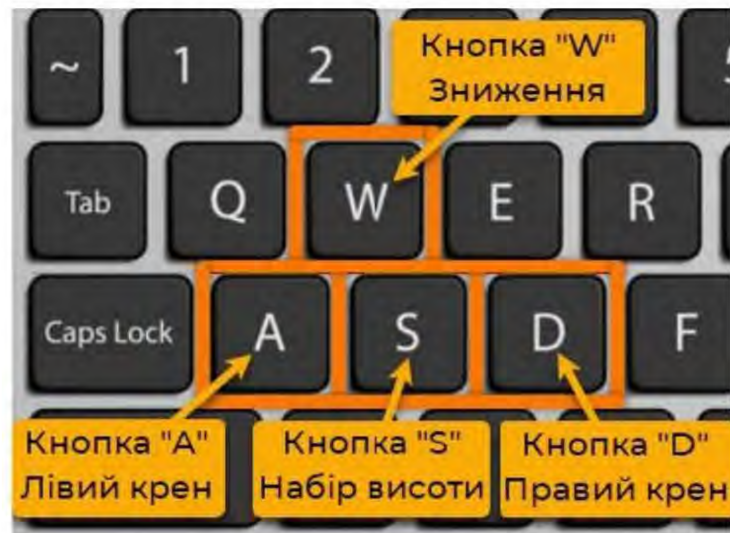
Рис. 11 Кнопки управления БпЛА в режиме "FBWB"
