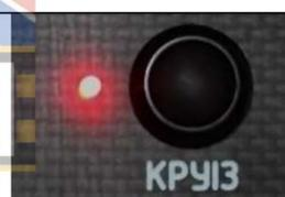
Кнопка "КРУИЗ" обеспечивает включение режима полета с автоматическим удержанием установленного курса и высоты
