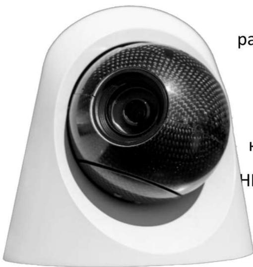
Оптический модуль дневной ОМД-1 обеспечивает ведение разведки в светлое время суток. Эффективная рабочая высота - до AGL 1200 м в зависимости от миссии. Оптический модуль дневной ОМД гиросtabilизирован по 2-х осям, что позволяет компенсировать колебания БпЛА и обеспечить стабильное изображение на мониторе НПУ. Дополнительную стабилизацию обеспечивает система цифровой стабилизации. Оптический модуль оснащен 10-х кратным оптическим и 12-х кратным цифровым зумом.
