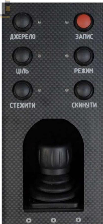
Управление полезной нагрузкой осуществляется с помощью блока управления полезной нагрузкой, который расположен на нижней панели НПУ слева от клавиатуры.
