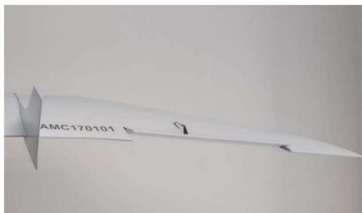
на фото), далее одним движением, **распрямляя** руки, подоросить БПЛА на 20-30 см вверх, одновременно отпустив его обеими руками. В этот момент **крайне важно сохранять выставленный угол тангажа 10-15°** до момента схода БПЛА с рук.
