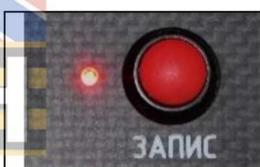
Кнопка "ЗАПИСЬ" обеспечивает включение/выключение видеoinформации с помощью Бортового записывающего устройства.
