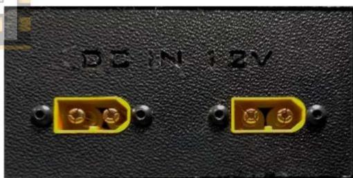
а) Питание от АКБ осуществляется путем подключения двух батарей постоянного тока **12V** к разъемам XT60, расположенных в батарейном отсеке НПУ.
