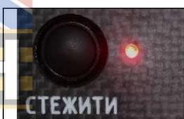
Кнопка "СТЕЖИТЬ" (Удержание цели) обеспечивает включение режима автоматического сопровождения цели.
