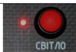
Кнопка "СВЕТ" обеспечивает включение/выключение бортовых аэронавигационных огней БПЛА.
