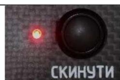
Кнопка "СКИНУТЬ" блока управления полезной нагрузкой НПУ позволяет перевести полезную нагрузку в такое положение, при котором направление зрения камеры совпадает с курсом носа БПЛА (рысканием). Подробное описание см. в п. 5.6.5.
