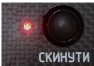
Кнопка "СКИНУТЬ" блока управления полезной нагрузкой НПУ позволяет перевести полезную нагрузку в такое положение, при котором направление зрения камеры совпадает с курсом носа БПЛА (рысканьем). Функция "СКИНУТЬ" имеет два режима: при первом
