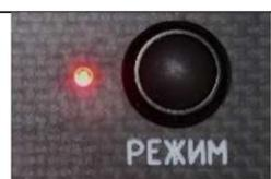
Кнопка "РЕЖИМ" обеспечивает переключение режимов полезной нагрузки.
