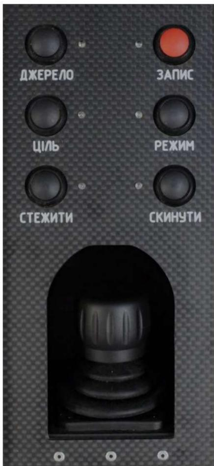
Управление БЛА осуществляется с помощью блока управления БЛА который расположен на нижней панели НПУ справа от клавиатуры.
