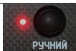
Кнопка "РУЧНОЙ" обеспечивает включение режима ручного управления с включенной электронной стабилизацией БПЛА.
