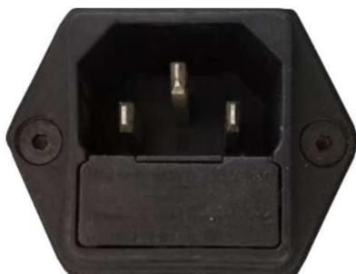
б) Питание от сети **220V** осуществляется путем подсоединения стандартного кабеля с разъемом IEC-C13 к гнезду IEC-C14, расположенному на задней нижней части НПУ.
