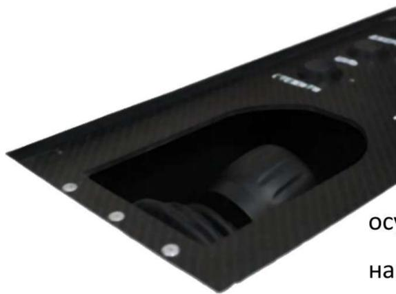
В ПОХОДНОМ (горизонтальном) положении манипуляторы прячутся внутрь нижней части НПУ с целью обеспечения безопасного закрывания НПУ после завершения выполнения миссии. Сборка манипуляторов осуществляется путем нажатия на ручку манипулятора в направлении "от себя" до изменения положения на производное.
