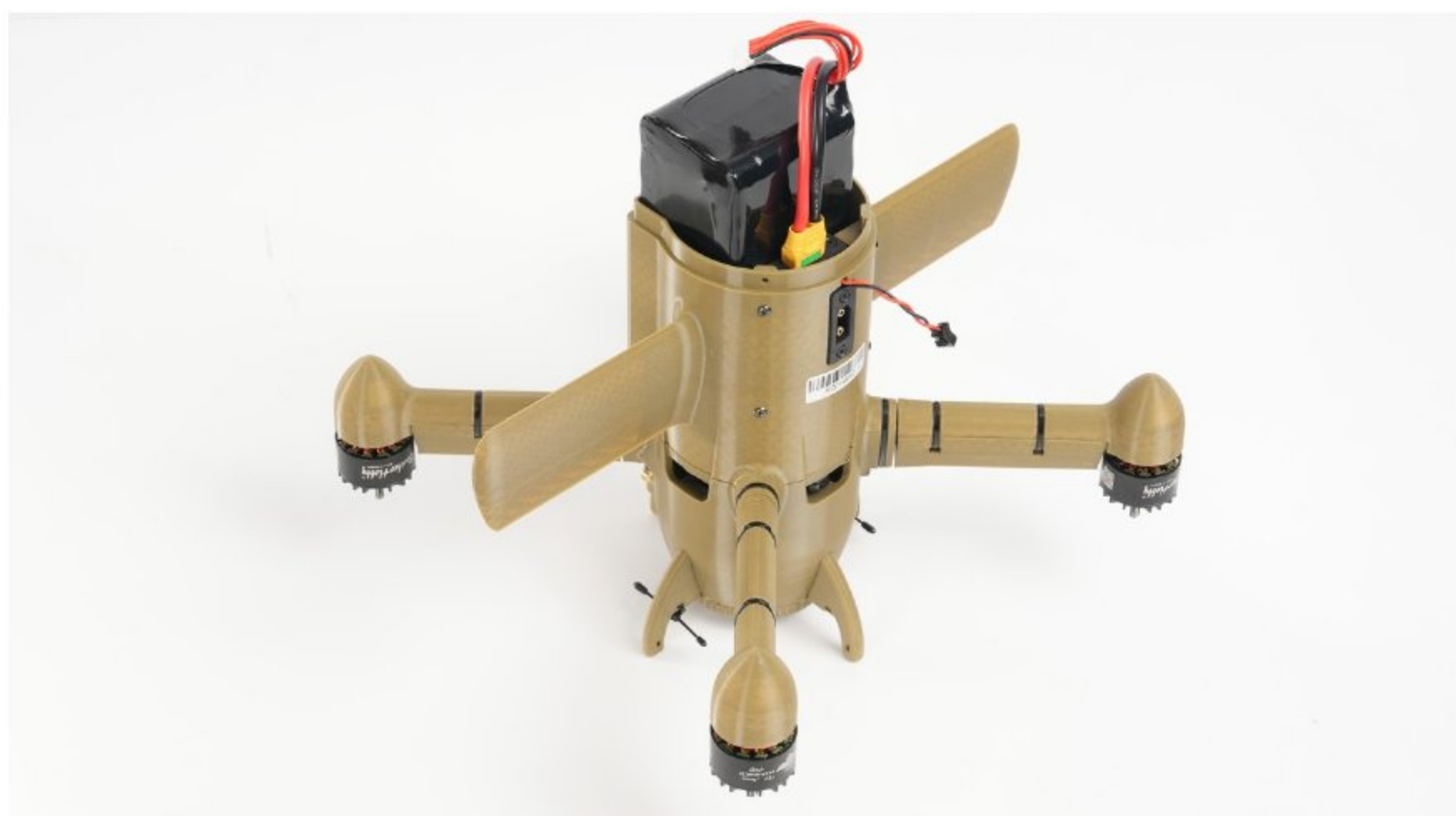
Рис. 57. Аккумуляторная батарея установлена и подключена (пропеллеры не показаны)
