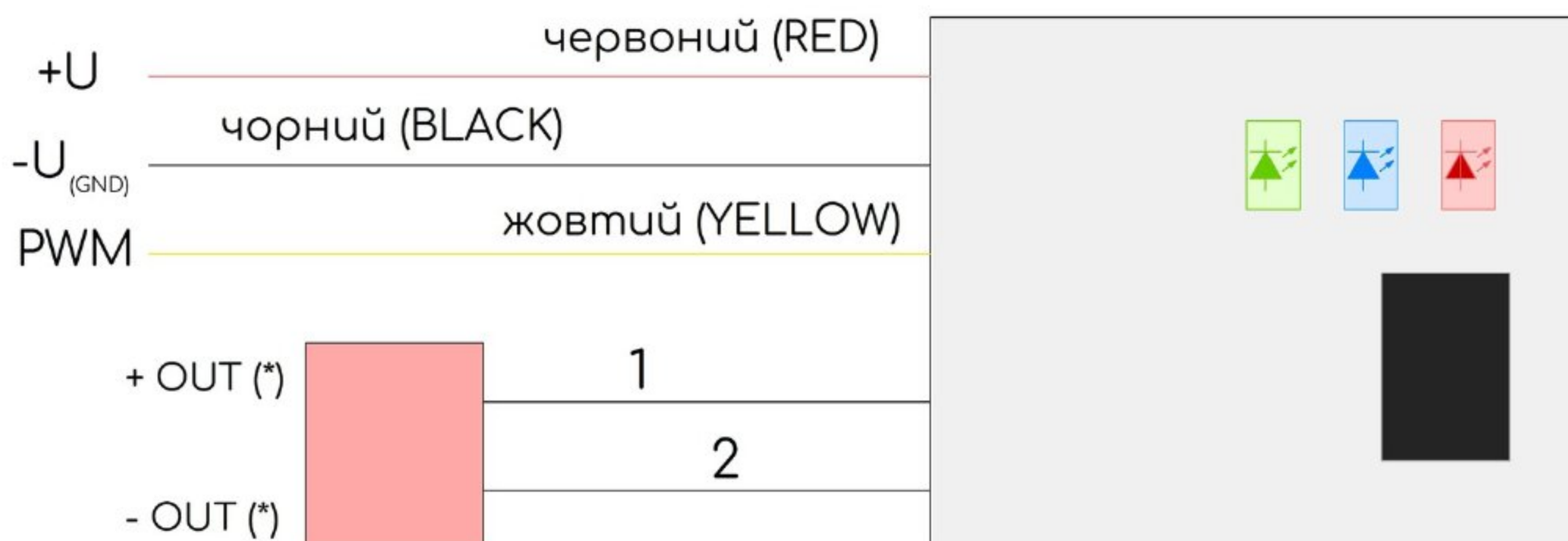
Рис. 22. – Схема подключения платы инициирования АЭД-01
