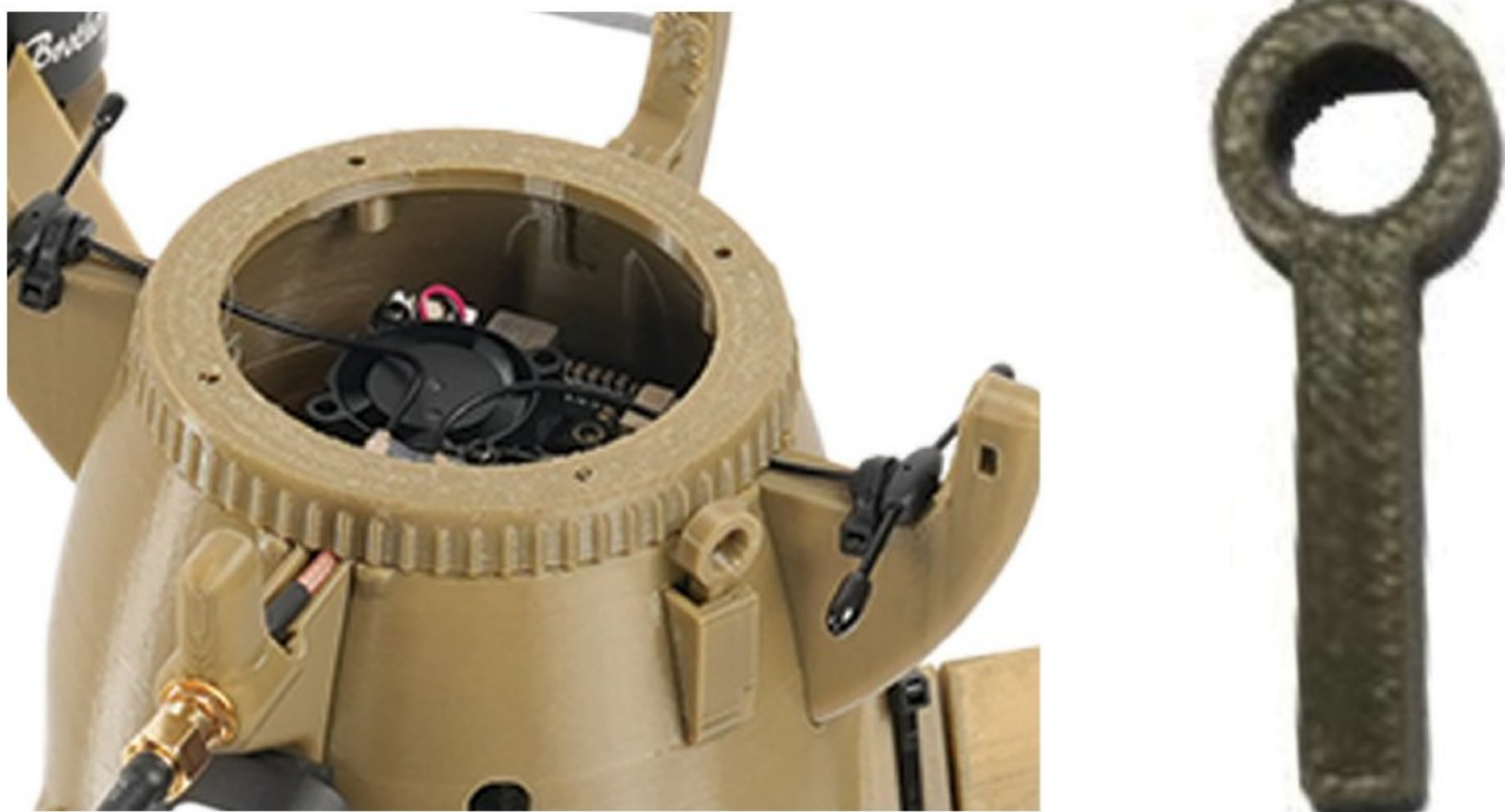
Рис. 20. Место установки чеки и ее внешний вид (чеку сфотографировать дополнительно)
