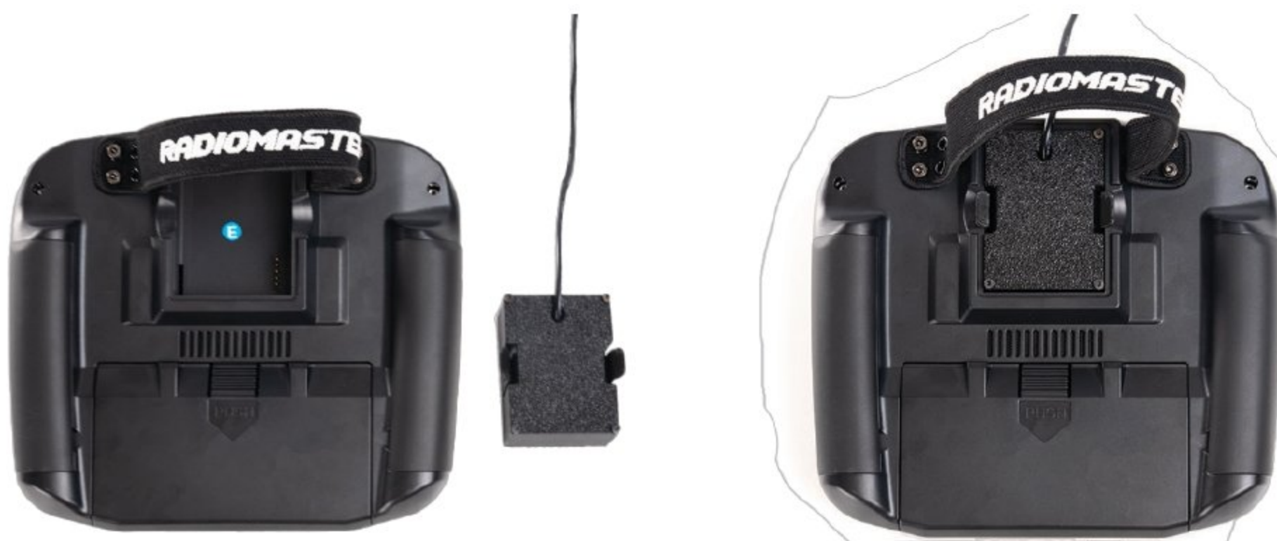
Рис. 6. Вид слева — адаптер пульта. Вид справа — смонтированный адаптер.
