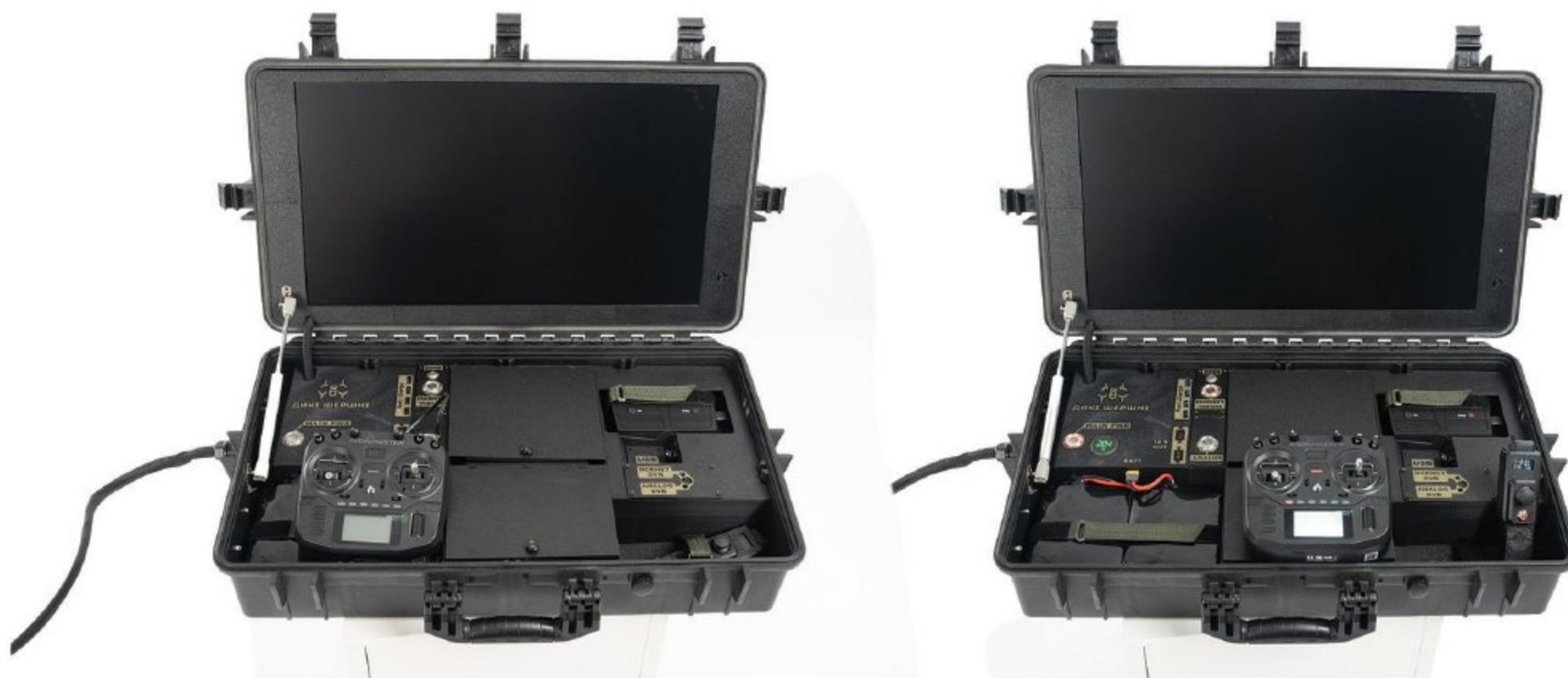
Рис. 31. Подключение кабеля от трансивера, включение режима «HORNET VISION»
