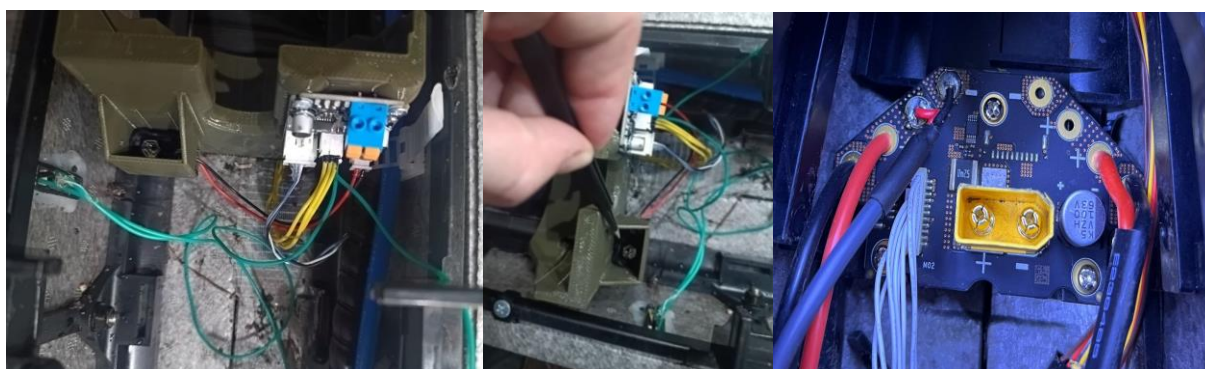
Рисунок 17 Место установки батарейки "Крона" или 6F22 собственного питания инициатора
