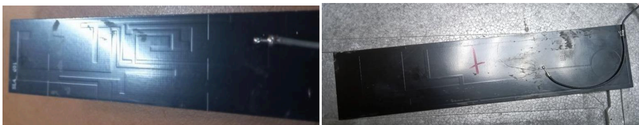
Рисунок 24 Как выглядит антенна канала управления и их согласование по сопротивлению и соответственно по КСВ: слева 169МГц, справа 470МГц
