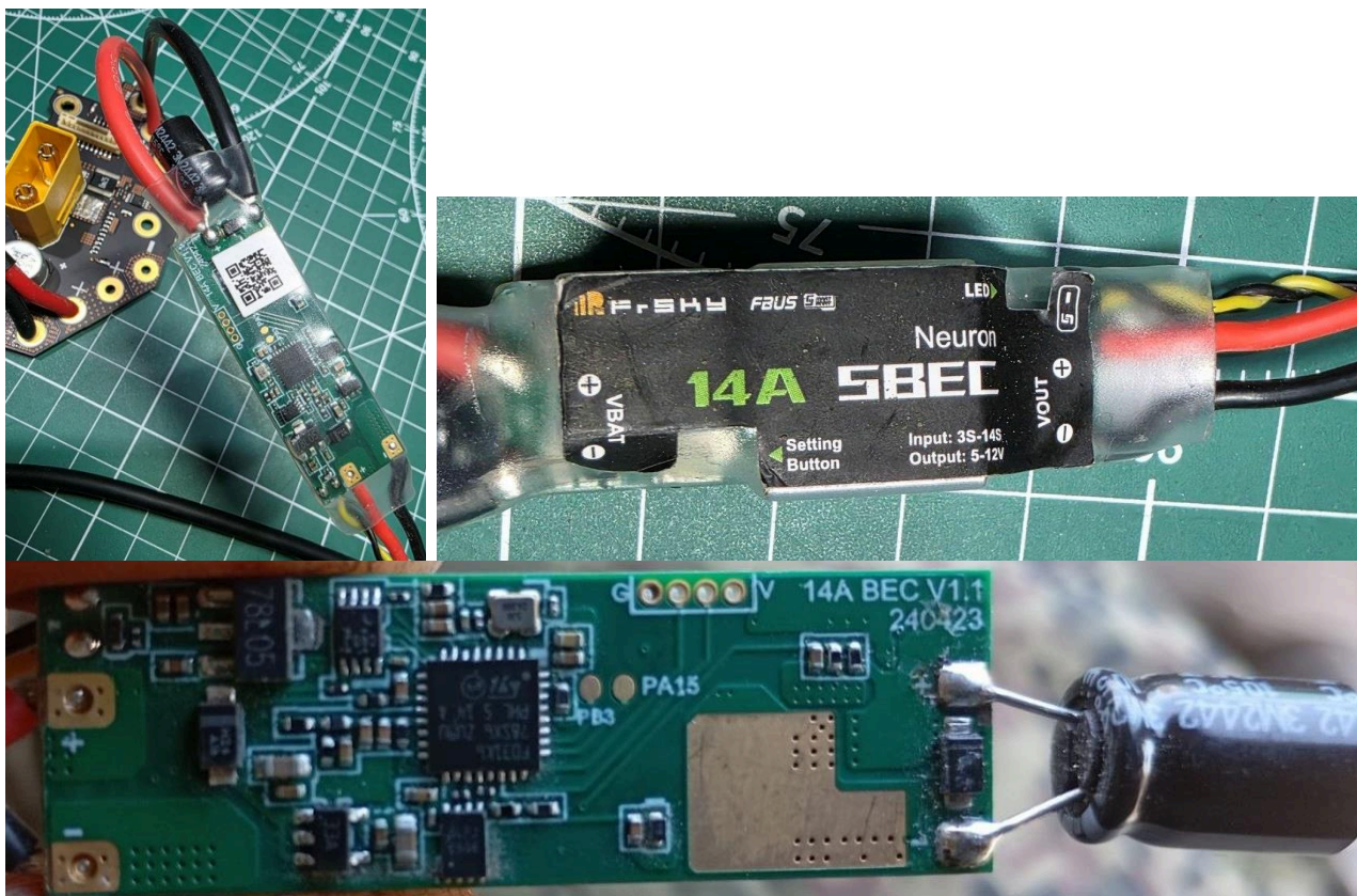
Рисунок 12 Понижающий стабилизатор напряжения FrSky Neuron 14A SBEC с выходным напряжением 5-12В и током до 14А при охлаждении/10А в долговременном режиме. В документации это не оговаривается, но входное рабочее напряжение регулятора может достигать 55В.
