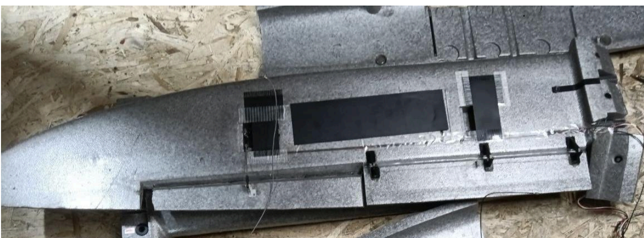
Рисунок 26 Расположение антенн канала управления по протоколу LoRa 169 МГц и 470 МГц
