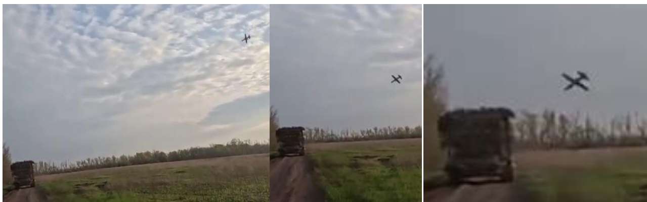
Рисунок 10 Пример автоматического пикирования под углом 45* на цель.
