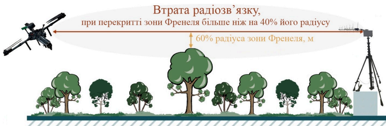
Рисунок 113. Схематическое изображение свободных 60 % радиуса зоны Френеля.
