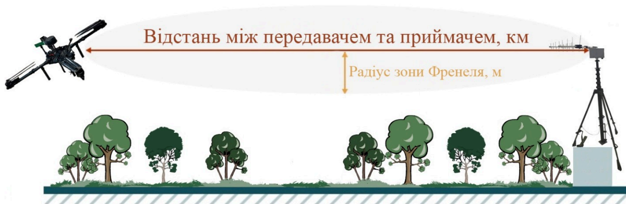
Рисунок 111. Схематическое изображение зоны Френеля и ее радиуса.
