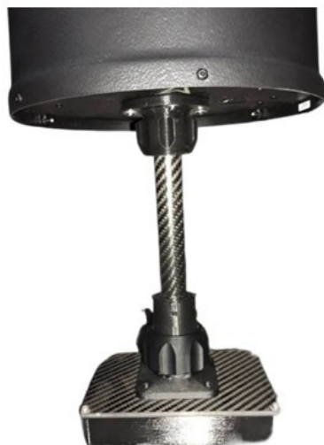
Рисунок 10. Установленная GNSS-антенна UNA-3
