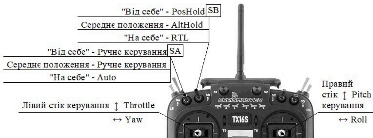
Рисунок 70. Переключатели режимов полёта и стики управления на ПДК SA – Переключатель режима полёта Auto, SB – Переключатель режимов полёта
