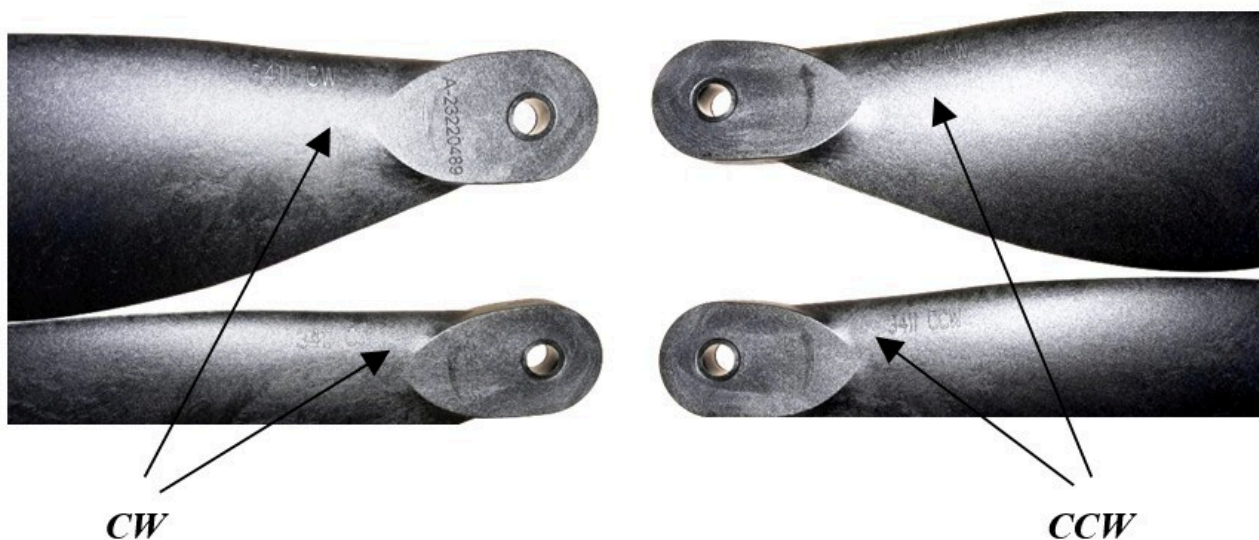
Рисунок 88. Маркировка лопастей CW и CCW
