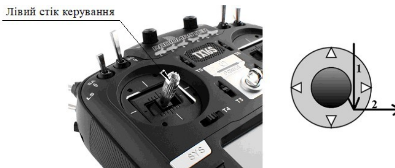
Рисунок 69. Расположение левого джойстика управления ПДК и порядок запуска двигателей (arm). Достигнув минимальной безопасной высоты, проверьте в ПО типа MP или
